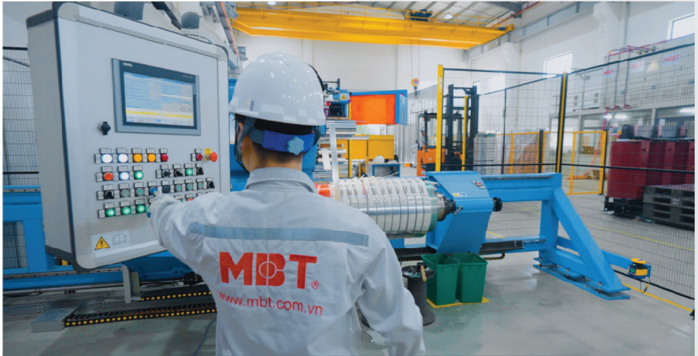
MÁY QUẤN CAO THẾ TỰ ĐỘNG LAE ITALY LAE ITALIA AUTOMATIC HIGH VOLTAGE WINDING MACHINE
